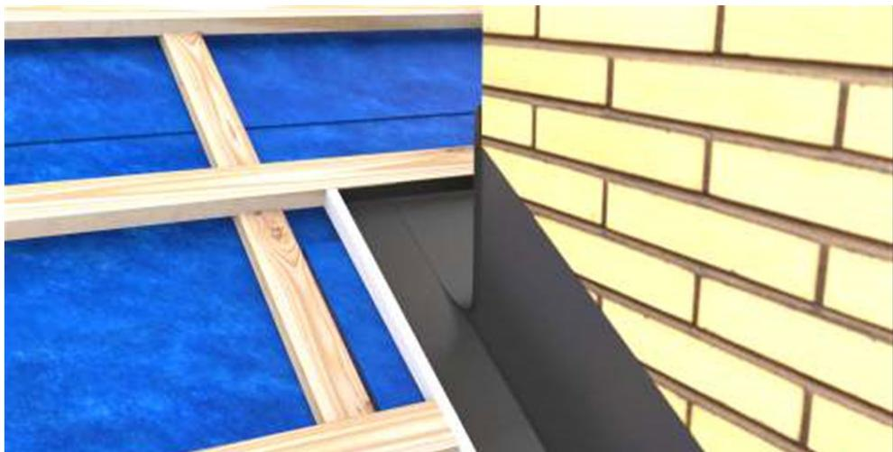
Kanteile - Die Hinterseite ist so zu formen, dass sie an die erste Latte hinter dem Schornstein angebracht werden kann.
