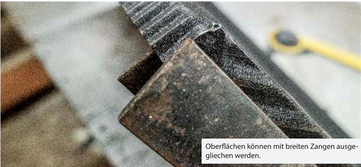
Oberflächen können mit breiten Zangen ausgeglichen werden.
