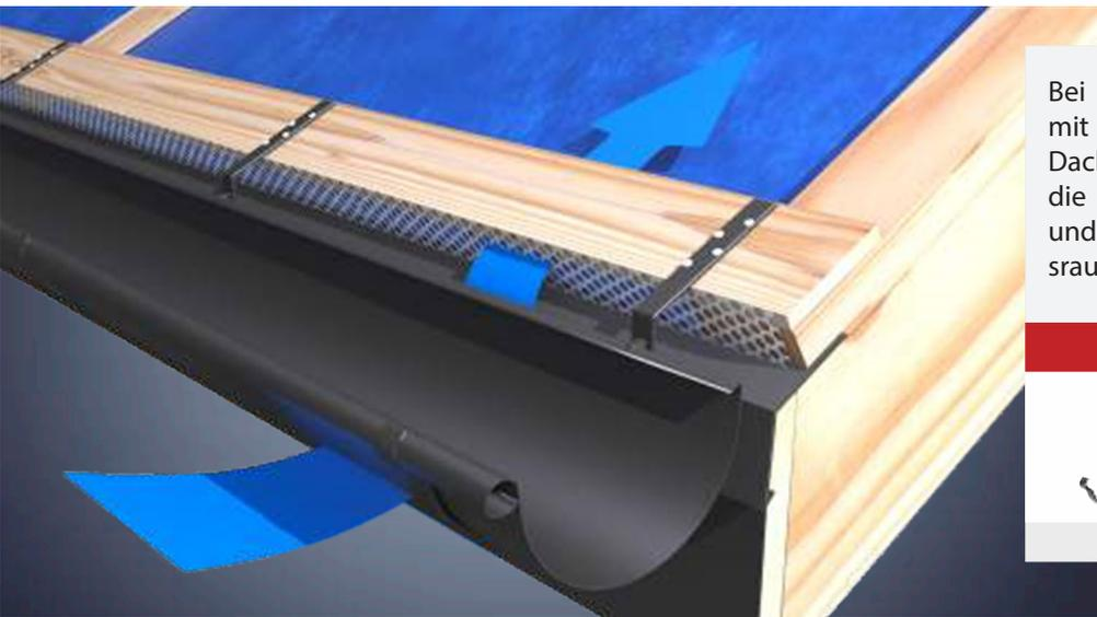
Bei einem Dach mit bewohntem, mit Wohndachfolie vorgedichtetem Dachgeschoss (sog. Membran), wird die Verwendung von Sparrenhaken und die Anfertigung eines Ventilationsraum unter der Rinne empfohlen.
